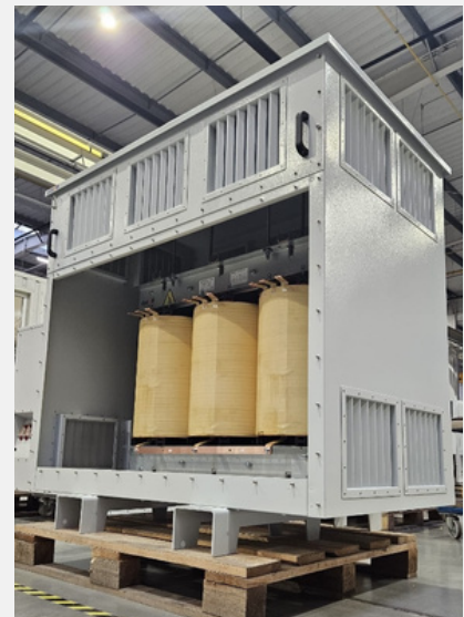
REACTORS: ED3K 545 KVAR ORAZ 345 KVAR PHOTO: ELHAND TRANSFORMATORY
